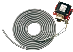
Vetokytin, jossa on muovinen vetököysi Asennus vaaka- tai pystysuoraan, painevalettu alumiinikotelo, IP65, vetököyden pituus 4 m
